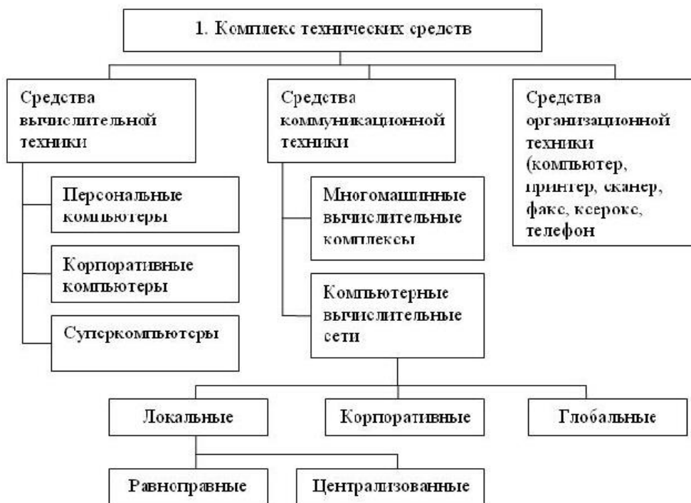
Рисунок 1 - Структура комплекса технических средств АИТ
